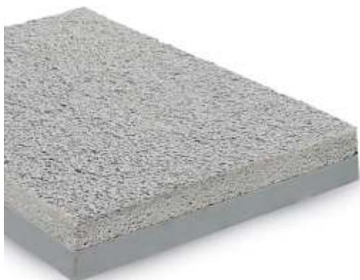
El producto está constituido por una plancha de poliestireno extruido, de 40 a 80 mm de espesor, unida a una capa superior de mortero de cemento de 35 mm, a base de agregados minerales seleccionados y aditivos especiales. La INVERLOSA, de color gris, posee un acabado poroso filtrante constituido por áridos seleccionados, de 0 a 4 milímetros, que funcionan como capa de protección mecánica.
