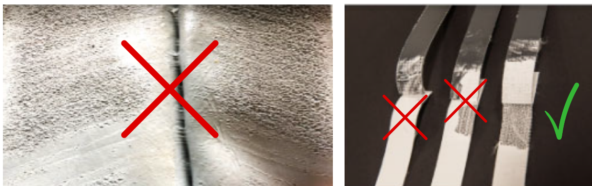
Figura 43. Soldadura incorrecta (Izquierda) / Tiras para la prueba de soldadura (Derecha)
